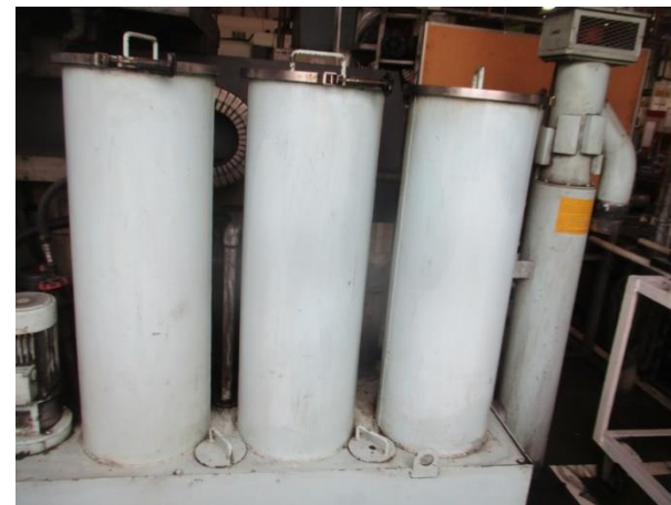
รูปที่ 2-42 ระบบกรองน้ำมัน (Oil filter) ในขณะชุบน้ำมันกันสนิม
