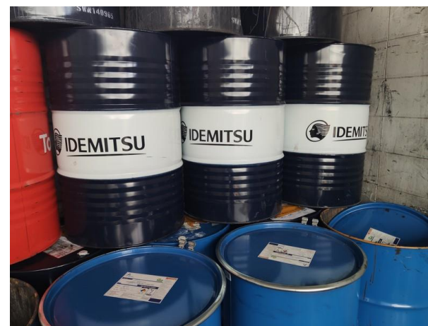
รูปที่ 2-43 ภาชนะรองรับการถ่ายน้ำมัน ที่มีฝาปิดมิดชิด และเคลื่อนย้ายไปเก็บที่โรงเก็บของเสียอันตรายพร้อมติดป้ายชี้บ่ง
