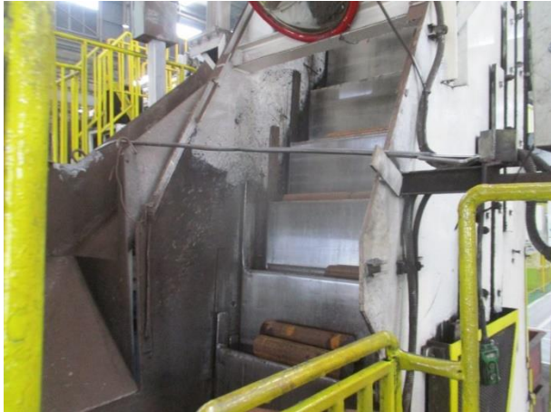
รูปที่ 2-34 ชั้นพักชิ้นงานในการลำเลียงเหล็กที่ร้อนของสายพานลำเลียงที่ไหลเข้าสู่ห้องอบให้ความร้อน
