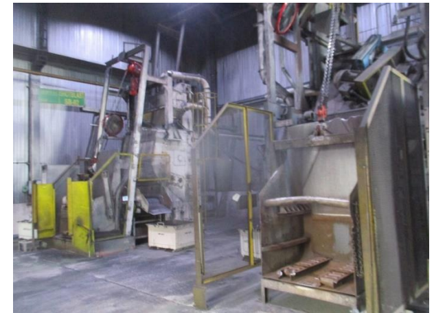
รูปที่ 2-35 ฐานรองเพื่อลดความสูงของรางลำเลียงชิ้นงานที่ออกจากขั้นตอนการผลิตลงสู่กระบะเหล็ก รองรับชิ้นงาน
